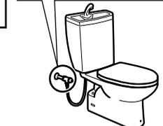
マイナスドライバーで右に止まるまで回して、止水栓を閉める。
